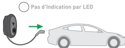
**3** - Insérez la fiche de charge dans l'entrée du véhicule et le voyant d'état s'allume en vert.
