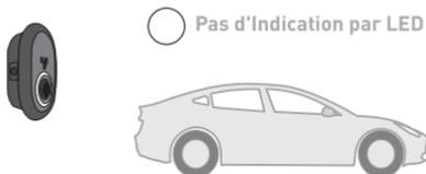
**2** - Insérez la fiche de charge dans la prise d'entrée du véhicule et dans la prise de la station de charge.
